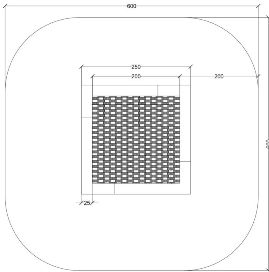
Hopperedskabet er designet til udendørs brug og er enkel at montere. Vores certifikat overholder de europæiske standarder "4.2.16 hoppe faciliteter" EN 1176-1 del 1: Generelle sikkerhedskrav og testmetoder", som garanterer et sikkert produkt.
